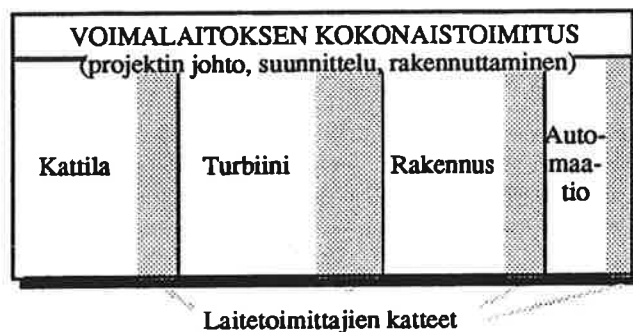
Kuva 5: Voimalaitoksen turn key -toimituksen pääkomponentit
